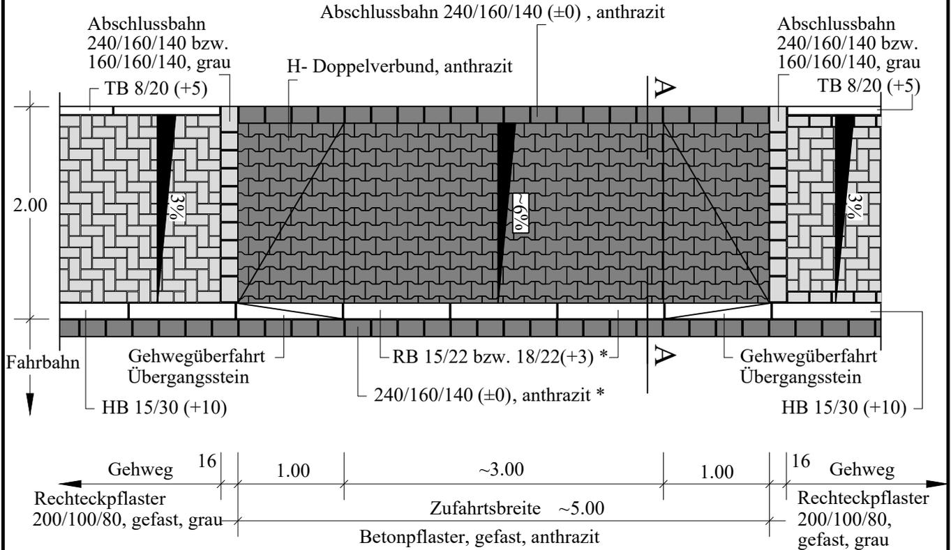
Alle Betonsteine in Läuferzeilen sind ebenfalls in gefaster Ausführungen zu verwenden.
