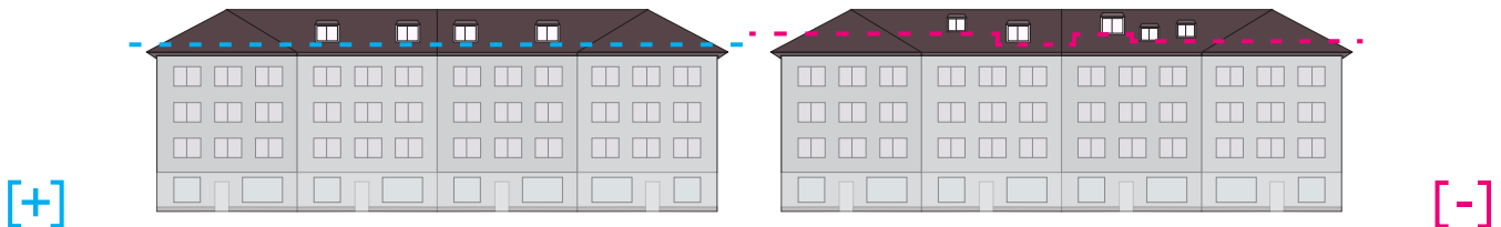
Abb. 145: Dachaufbauten fügen sich in Fassadenstruktur ein
