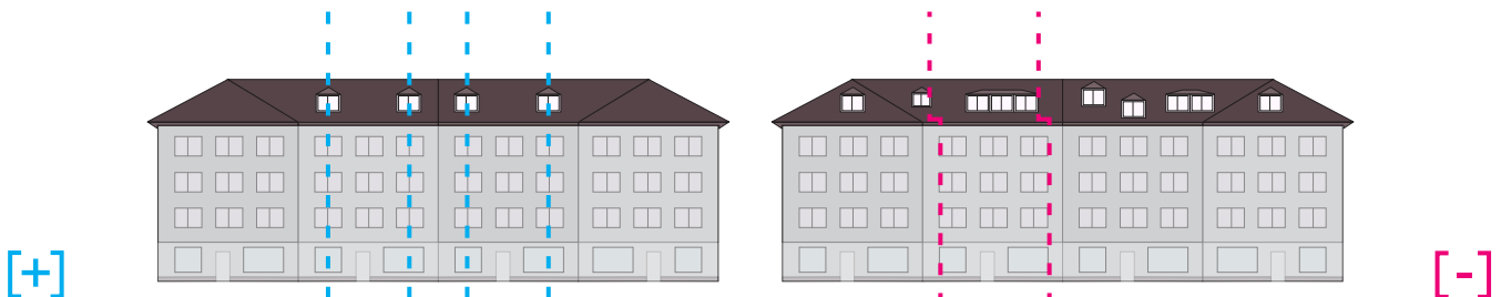
Abb. 146: Dachaufbauten nehmen Fluchtlinien auf
