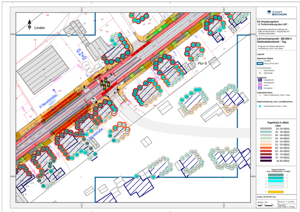
Abbildung 22: Hattinger Straße, (Pegelreduzierung durch RVA, Straßenquerschnittsgestaltung (Achsver-schiebung), Deckschicht mit Splittmastixasphalt (SMA 8) u. Hst.-Umbau)
