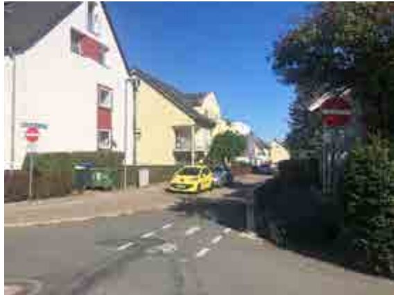
Abbildung 30: Für den Radverkehr geöffnete Einbahnstraßen inkl. Einfahrtsmarkierung
