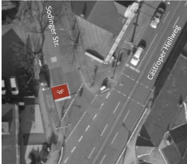
Abb. 15: Vorgezogene Aufstellfläche an der Einmündung Sodinger Straße
