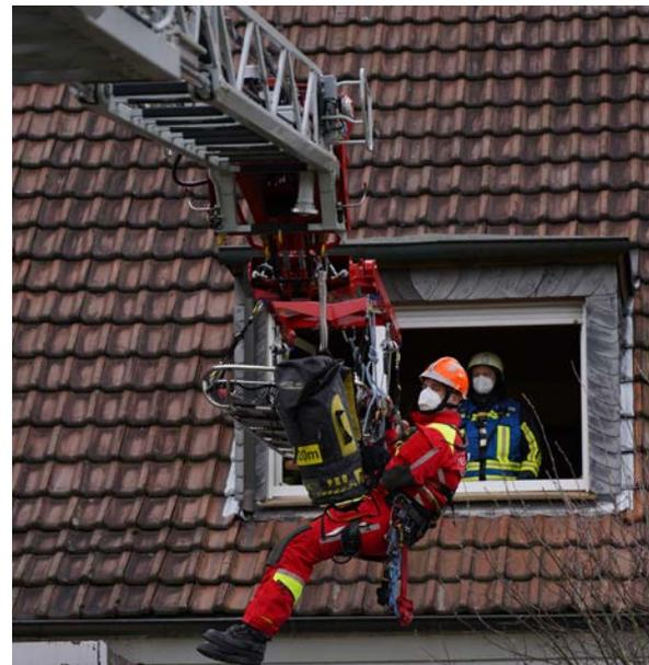
Personenrettung durchführen zu können. Damit der Rescue-Loader eingesetzt werden kann, muss vorher der Personenkorb von der Drehleiter abmontiert und anschließend durch den Rescue-Loader ersetzt werden.
