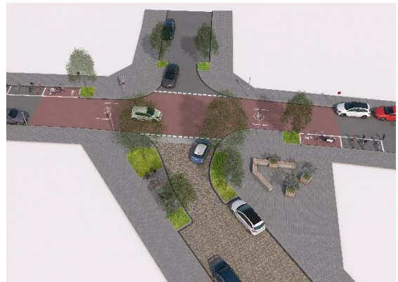
Verbesserte Sichtverhältnisse zur Querung an Knotenpunkten, Visualisierung
