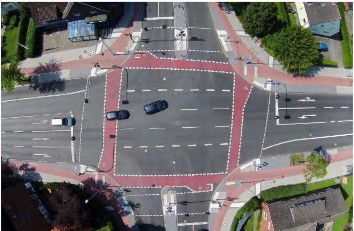
**Abbildung 23: Roteinfärbung und Aufstellbereiche für indirektes Abbiegen im Knotenpunkt**
