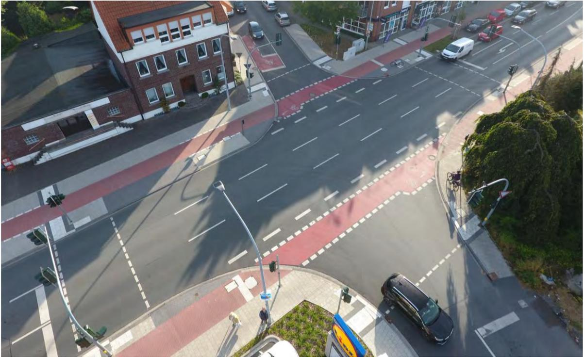
**Abbildung 25: Aufgeweitete Aufstellstreifen für direktes Linkseinbiegen aus der Nebenrichtung sowie Aufstellbereiche für indirektes Abbiegen aus der Hauptrichtung in Münster**
