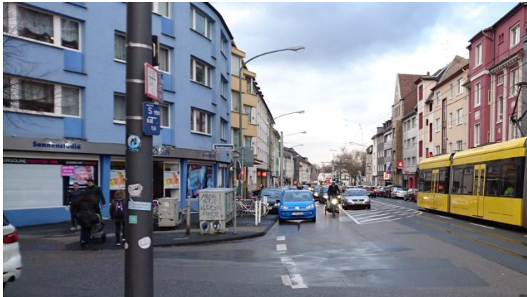
Abbildung 34: Typische Störung auf der Strecke: Bedingt durch Parken in zweiter Reihe wird der MIV auf den mit Sperrfläche geschützten Bahnkörper gedrängt, gleichzeitig überholen Pkw den Radverkehr (Beispiel: Witteringstraße).
