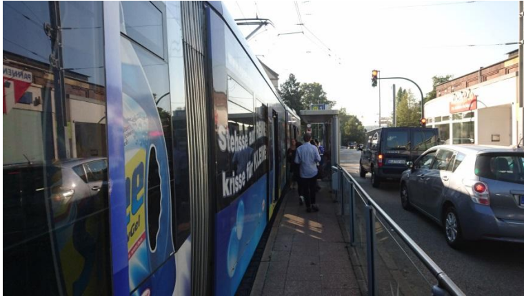
Abbildung 48: An Bahnsteigen mit geringer Breite sind die Rollstuhlrampen nicht einsetzbar (Haltestelle Zeche Ludwig)
